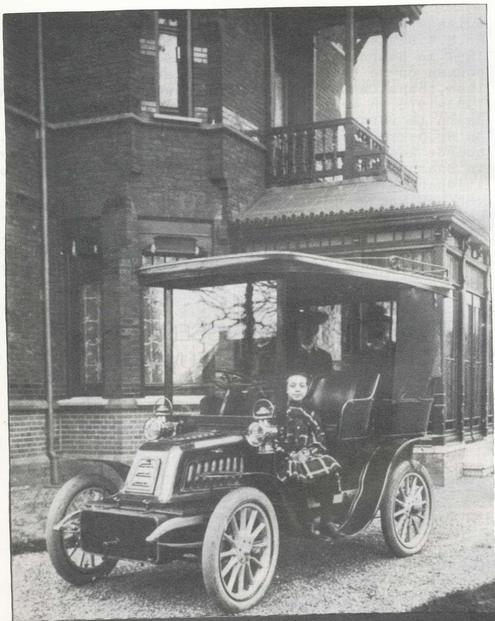
Onze eerste automobiel, welke mijn vader in 1904 aanschafte: een 2 cylinder 10/12 HP. Clément Bayard 1904. [redacted] De ketting boven het achterwiel diende als spijkervanger.
